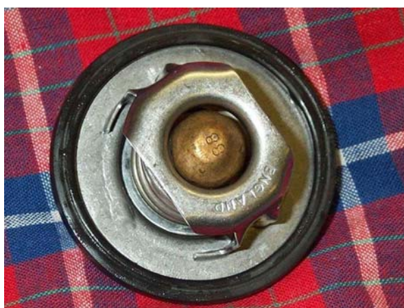
valvola termostatica originale, tarata ad 88° C
