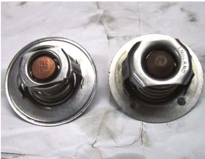
Termostato a 82° accanto all'originale ad 88° C
