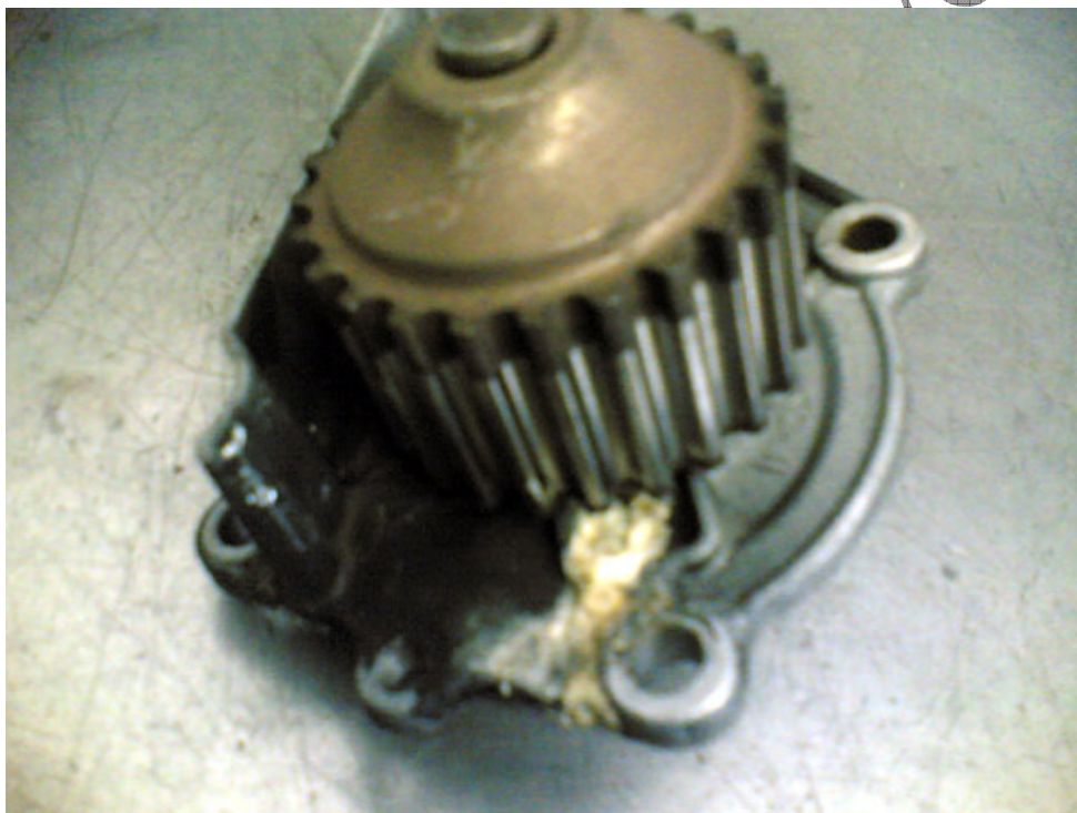
Esempio di pompa in perdita: notare la goratura bianca!
