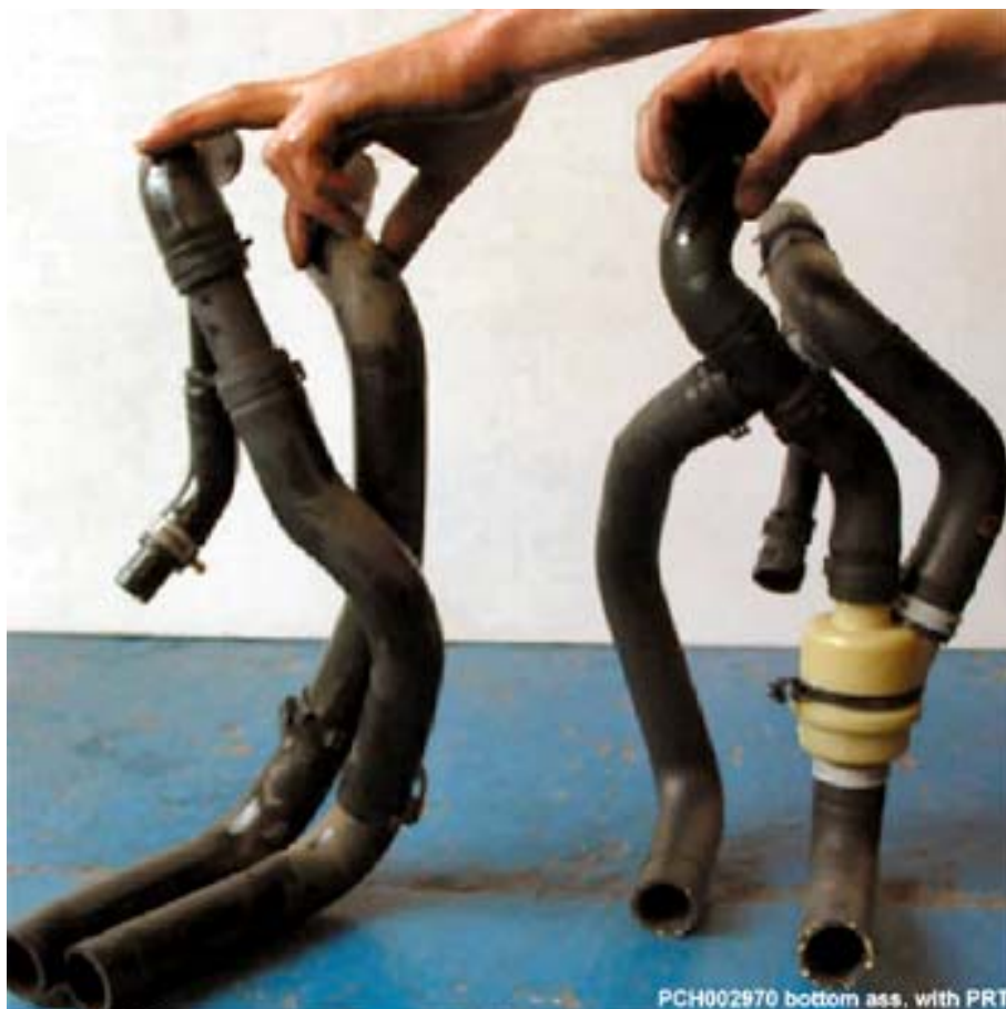
Foto della differenza tra parte dell'impianto vecchio (a sinistra) e il nuovo termostato PRT (a destra)
